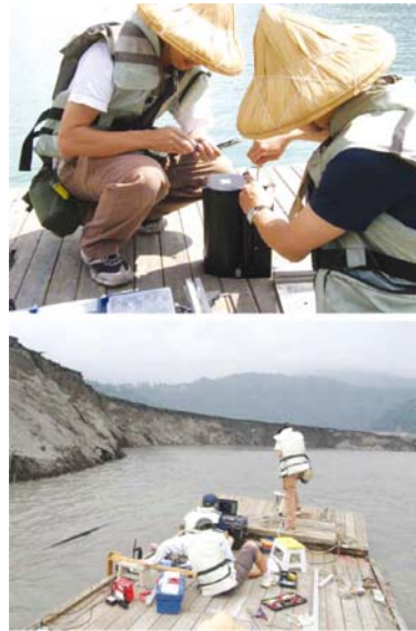
圖五：計畫研究者實地在霧社水庫測試監測紊流下沉積河床的聲波顯影策略。
